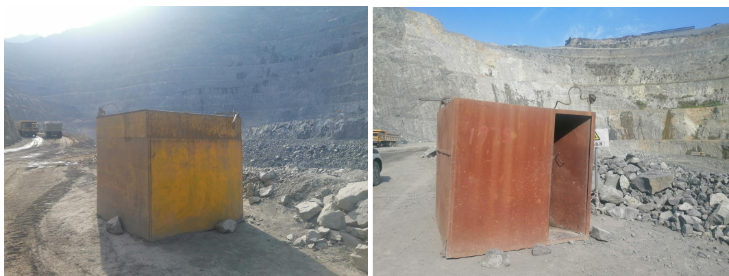
图 2.4.4-9 爆破安全设施
