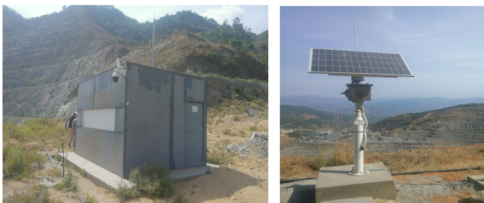
图 2.4.4-12 露天采场边坡监测设施图
