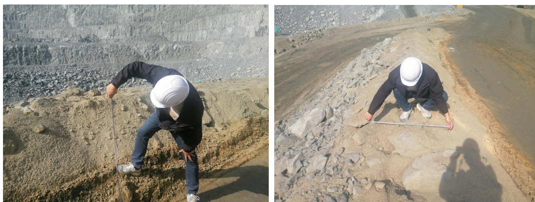
图 2.4.5-7 运输道路车挡设施
