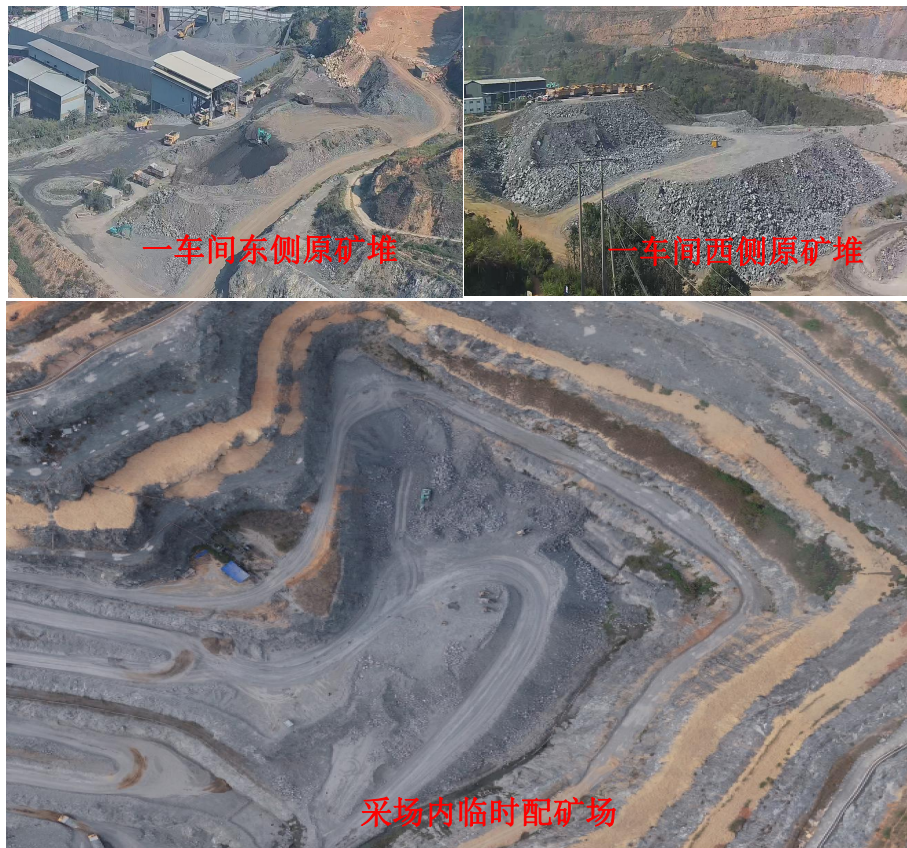
图 2.4.2-2 原矿堆场、临时配矿场
