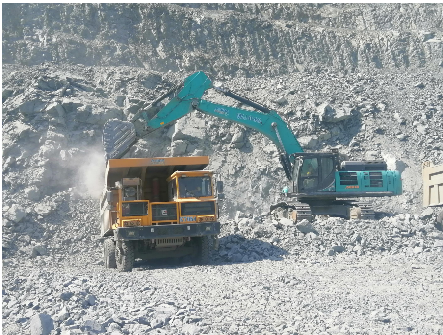
图 2.4.4-10 SK500XD-10ME 型液压挖掘机
