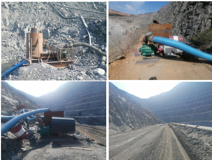
图 2.4.6-10 深凹机械排水系统
