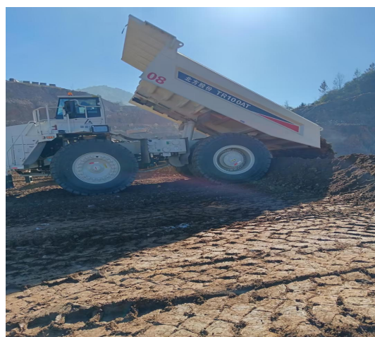
卸载点安全挡车设施
