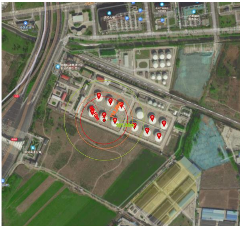
图 3.18.1-3 储罐池火灾事故伤害范围模拟图
