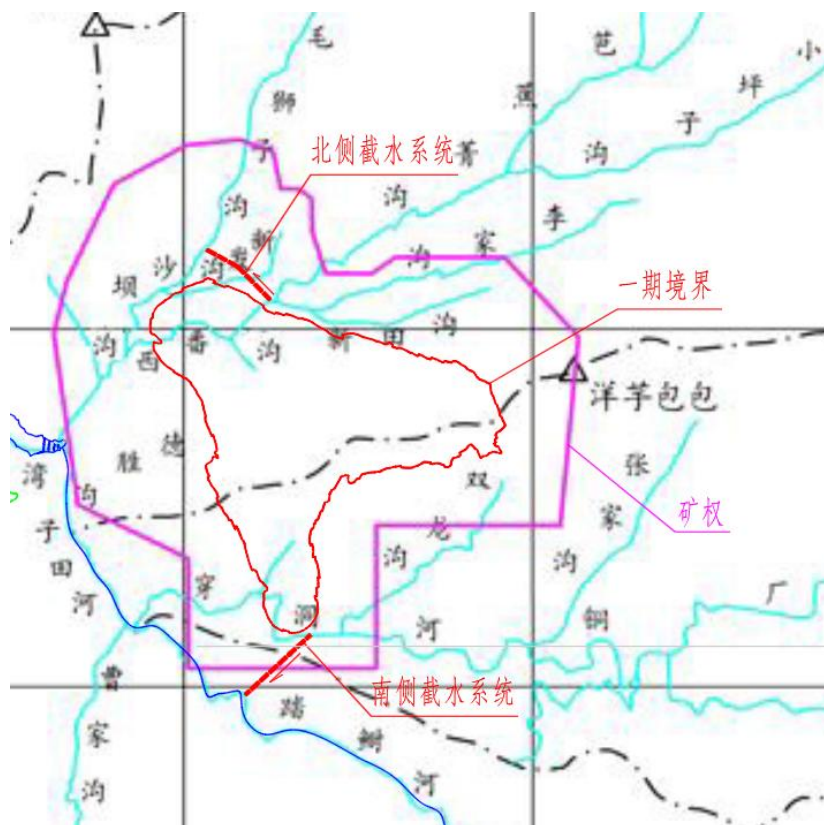
图 2.4.8-1 露天采场截水系统示意图
