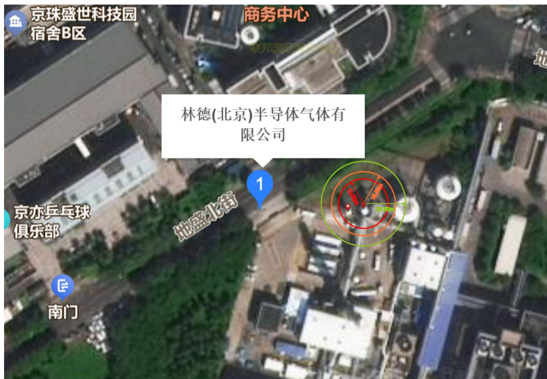
图 3.4-4 49.21m³ 高纯液氧储罐发生容器爆炸事故伤亡范围图
