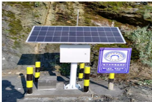
图 2.4.9-3 水位和渗透压力监测
