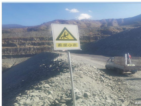
图 2.4.11-7 排土场安全警示标志牌
