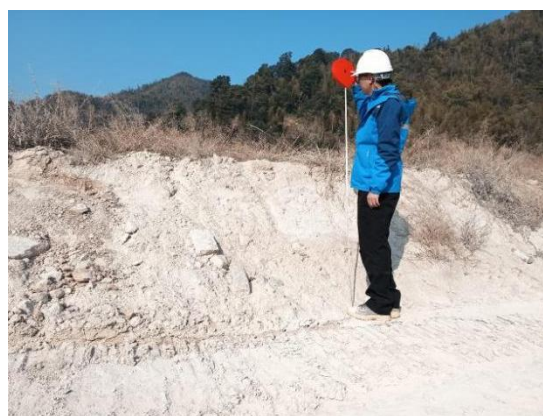
现场实测车挡高度
